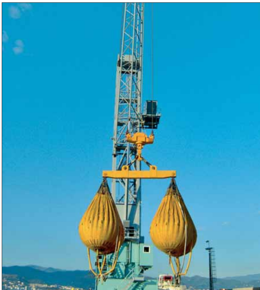
Con il sistema Water Weights si possono realizzare prove di carico fino a 600 t, grazie all'azione combinata dei palloni tramite appositi bilancini
