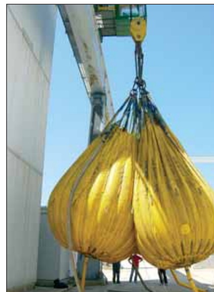
Gli involucri Water Weights sono facilmente trasportabili. Non occorre bilanciamento e imbracatura: sono collocati "a vuoto" e poi riempiti progressivamente in tutta sicurezza
