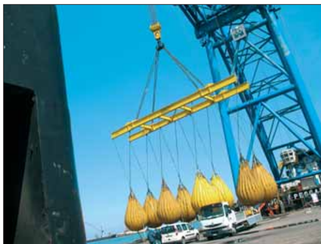
La metodologia di collaudo Water Weights, distribuita in esclusiva da A.T.S., prevede l'utilizzo di speciali palloni realizzati in PVC armato riempiti d'acqua
