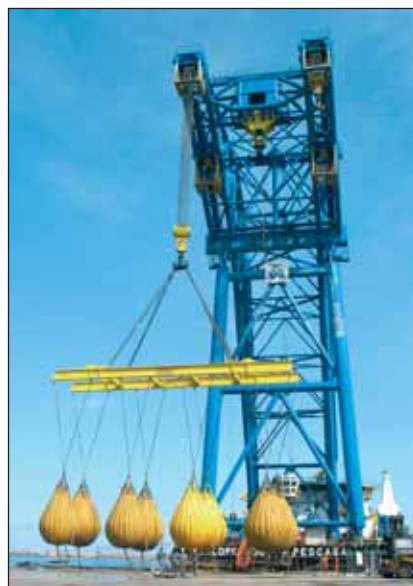
Il collaudo ha riguardato tre bilancini da 20 m circa di lunghezza e del peso di 22 t, ancorati su 16 punti, destinati alla movimentazione di moduli caldaia fino a 220 t di peso
