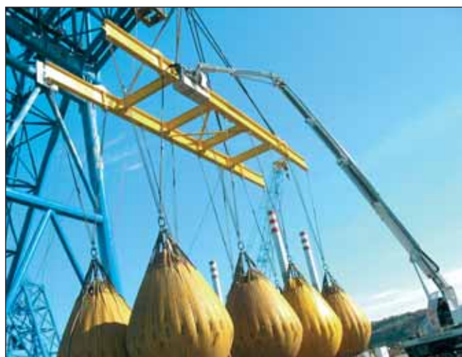
Il collaudo ha previsto l'applicazione di un carico di circa 280 t, ottenuto applicando ai 16 punti di ancoraggio dei bilancini otto palloni da 35 t l'uno
