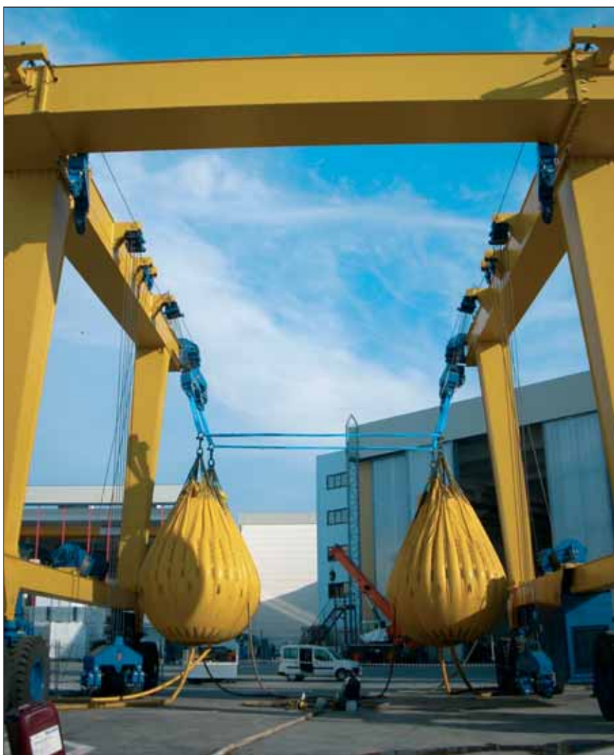
Alcune fasi del test al Polo Nautico: quattro prove per 110 t ciascuna
