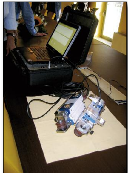
Tecnologia in cammino: lo strumento per il controllo magneto-induttivo delle funi, brevettato dal Politecnico di Torino in collaborazione con Ats
