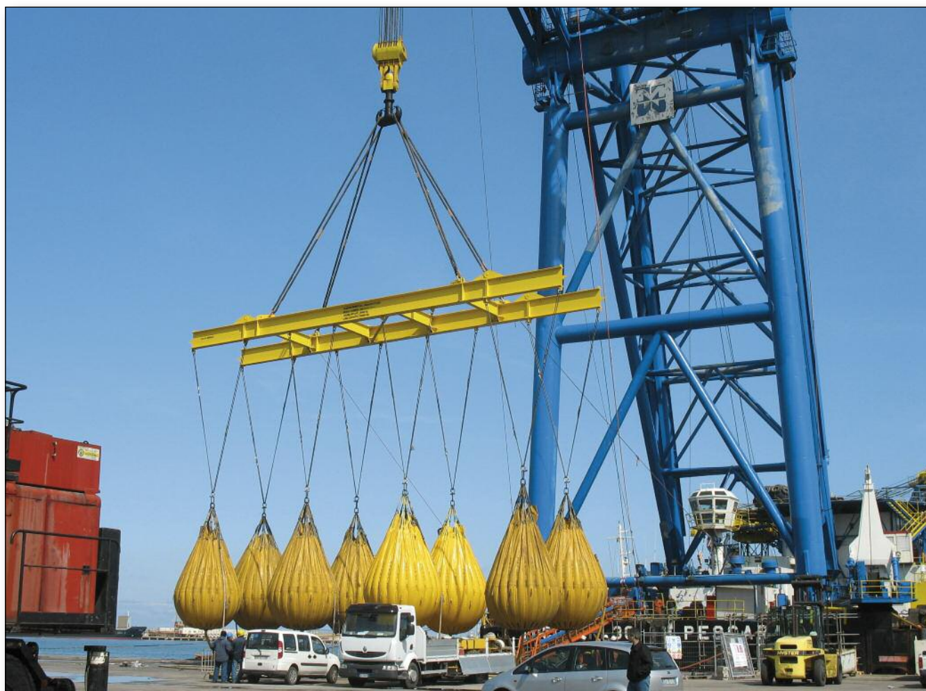
I "techno-palloni" riempiti ad acqua per la realizzazione dei test di carico rappresentano il core business di ATS
